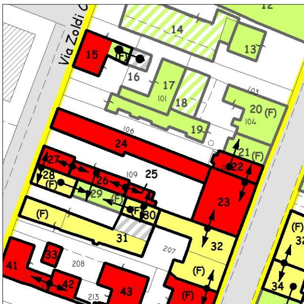
Esito della valutazione danni e perimetrazione UMI
