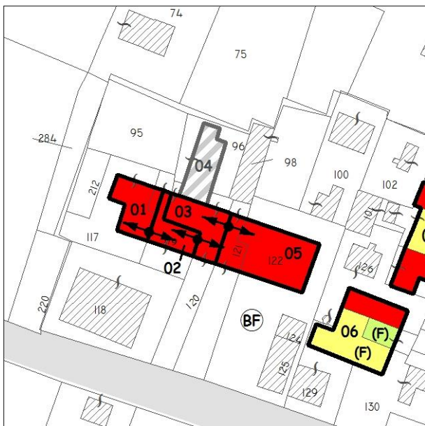
Esito della valutazione danni e perimetrazione UMI
