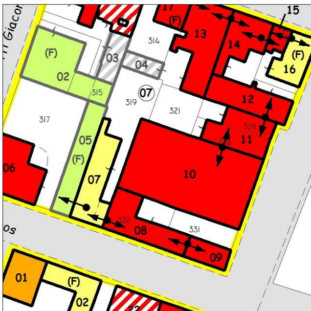
Esito della valutazione danni e perimetrazione UMI
