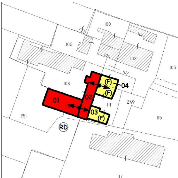
Esito della valutazione danni e perimetrazione UMI
