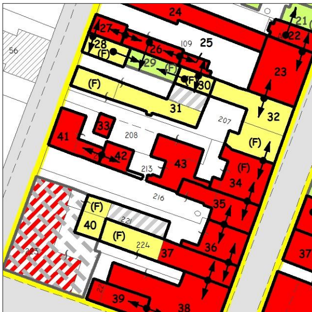
Esito della valutazione danni e perimetrazione UMI
