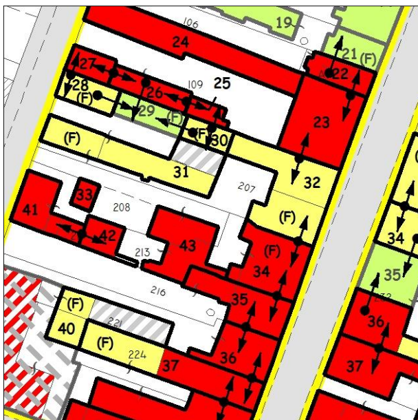
Esito della valutazione danni e perimetrazione UMI
