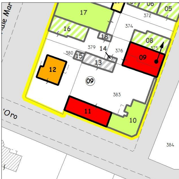
Esito della valutazione danni e perimetrazione UMI
