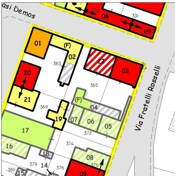
Esito della valutazione danni e perimetrazione UMI
