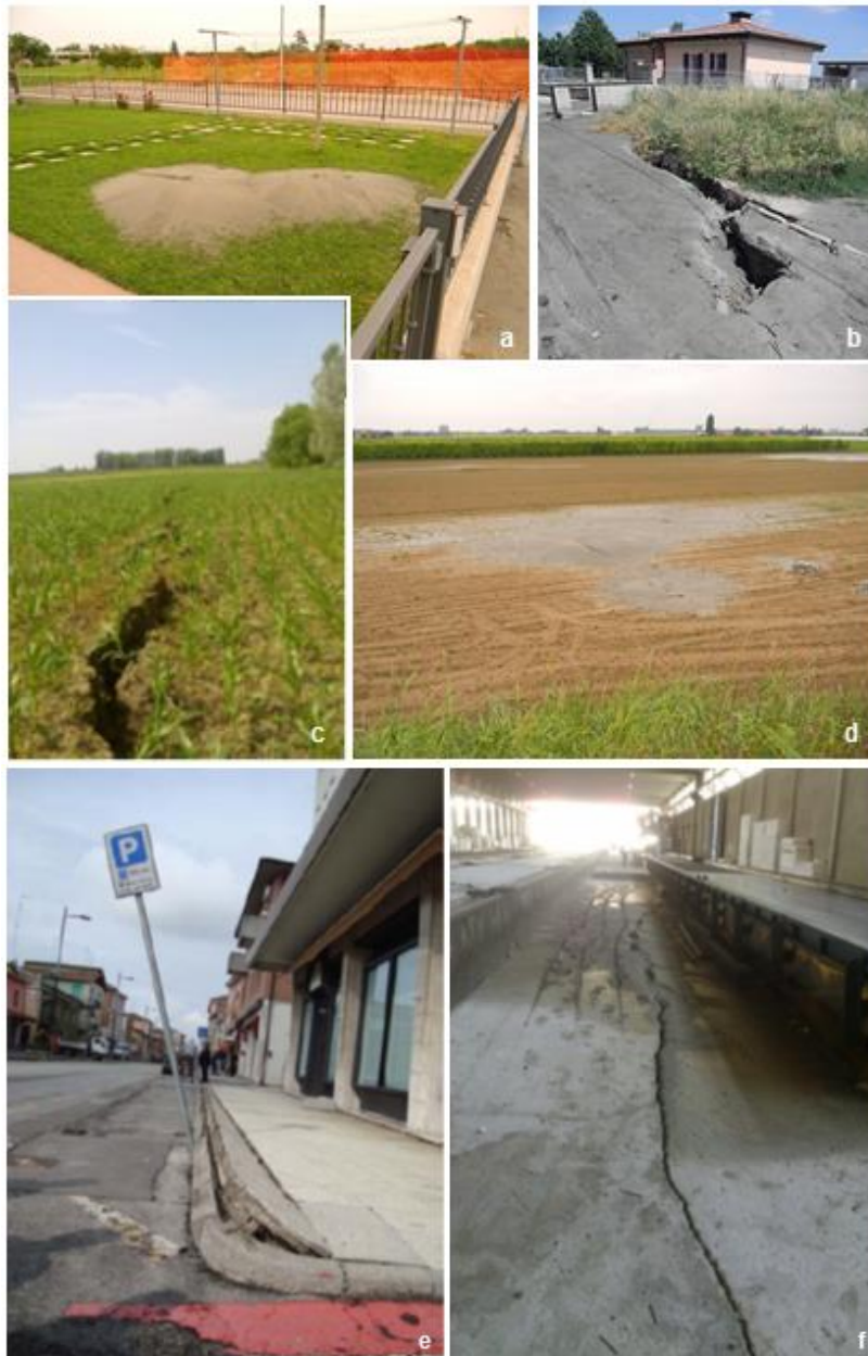
Figura 20: esempi di effetti di liquefazione osservati a S. Carlo, frazione di S. Agostino (FE), foto a-d, e a Mirabello (FE), foto e-f. Foto e-f cortesia Università di Firenze-DICEA
