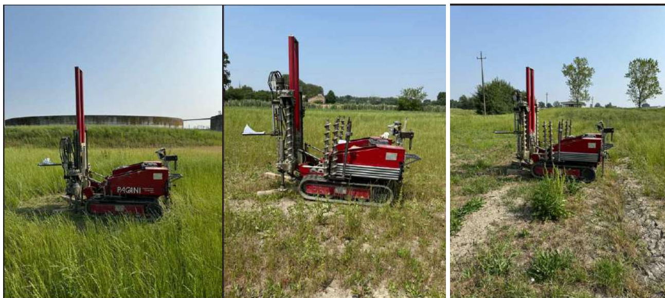
Fig.15. : Penetrometro statico sui punti di prova.
